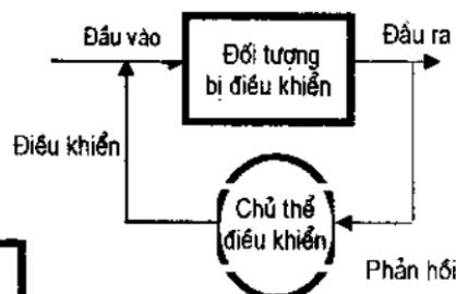
Hình 9: Sơ đồ điều khiển học của hệ thống
